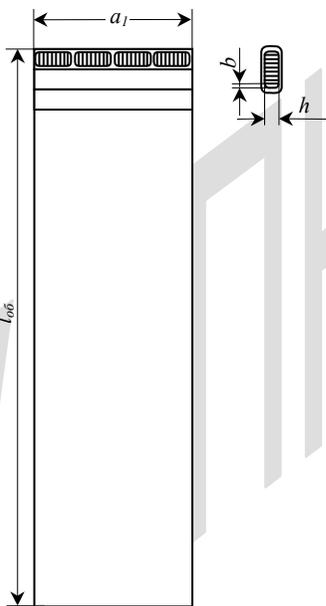
Рис. 1.2. Сечение катушечной обмотки, рядом показан один проводник в изоляции
