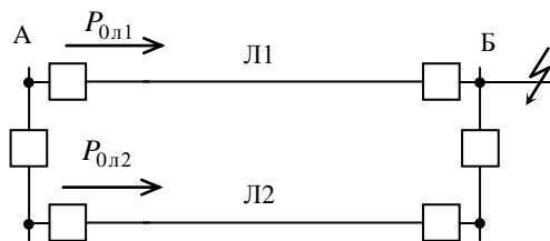
Рис. 3.7. Направление токов КЗ при внешнем КЗ
